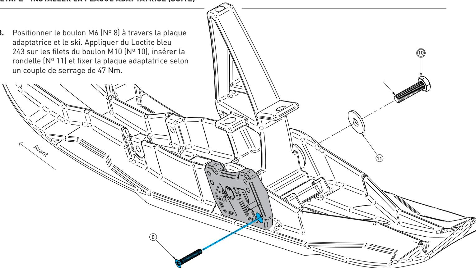
9. Visser l'écrou (N° 7) sur le boulon (N° 8) et appliquer un couple de serrage de 8 Nm.
