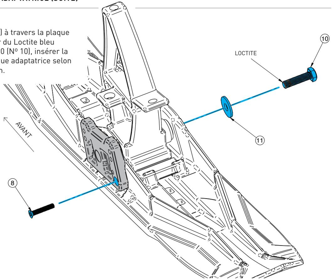
9. Visser l'écrou (N° 7) sur le boulon (N° 8) et appliquer un couple de serrage de 8 Nm.
