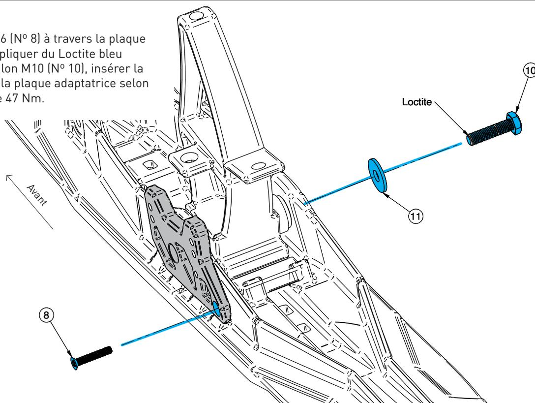
9. Visser l'écrou (N° 7) sur le boulon (N° 8) et appliquer un couple de serrage de 8 Nm.
