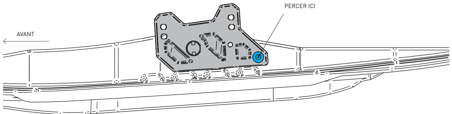
6. Retirer la grande douille du manufacturier et remplacer par la douille Kimpex (#16).
